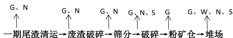
图 2-2 二期项目工艺流程及排污节点图
